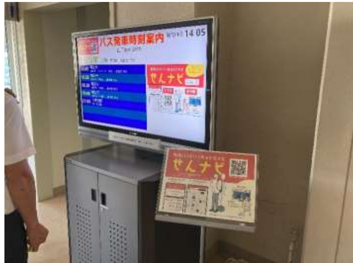
図 26 船木鉄道のバスロケーションシステムの表示機 (左：おのだサンパーク、右：山口東京理科大学)
