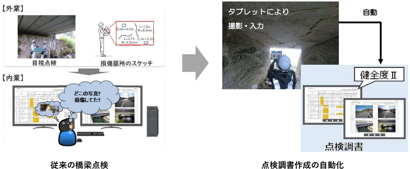
図- 3.3 新技術の活用 具体例（点検作業の省力化タブレット）
