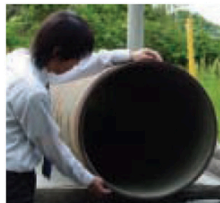
●水道管の大きさ (直径60cm)
