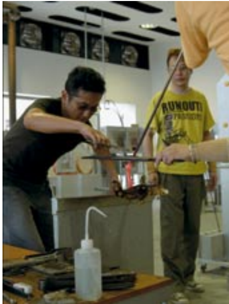
▲武永さん（写真左）と福西さんが共同作業で制作中の「わにのいれもの」。真っ赤に溶けたガラスを伸ばしながらくっつけ、ハサミで切って形を整えると、「わに」の足ができあがりました。（17ページをご覧ください。）
