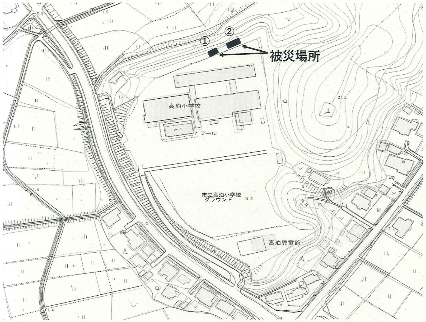
●高泊小学校北側法面崩落①市道側(縦7.5m×横6.5m)
